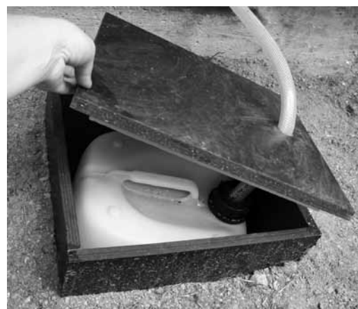
Obr. 3 Nádrž na shromažďování průsakové kapaliny
